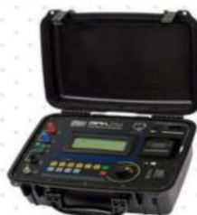
MICROHMIMETRO MARCA MEGABRAS MPK 256 10 AMPS.
